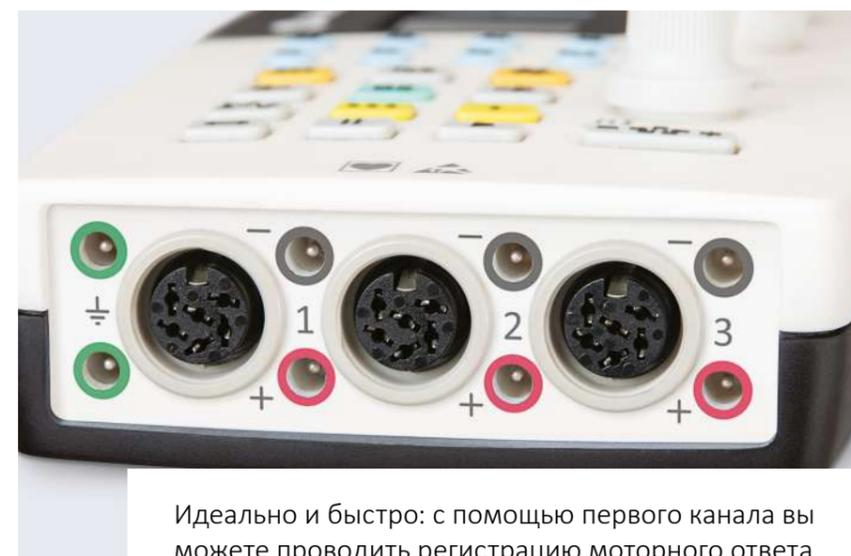
Идеально и быстро: с помощью первого канала вы можете проводить регистрацию моторного ответа, с помощью второго — сенсорного ответа, с помощью третьего — игольчатую ЭМГ. Больше не нужно постоянно перетыкать отводящие кабели. Пусть они прослужат вам еще дольше! Возможна одновременная регистрация по всем трем каналам прибора, например, для записи соматосенсорных ВП
