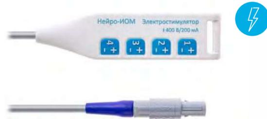
**Выносной блок для подключения стимулирующих электродов (4 канала, длина кабеля 5 м)**
