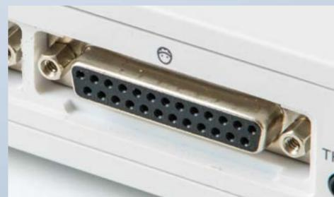
Стандартный разъем для подключения электродной шапочки дает возможность использовать для регистрации ЭЭГ электродные системы различных производителей.
