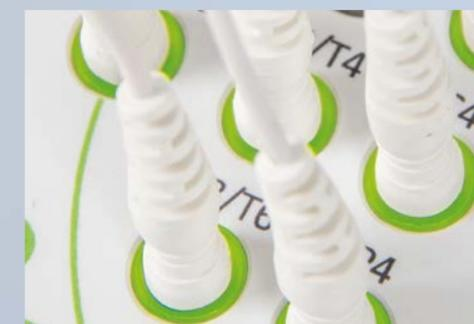
Индикация импеданса на блоке усилителя и непрерывное измерение импеданса в режиме регистрации дают возможность постоянно отслеживать и своевременно корректировать качество наложения электродов, добиваясь тем самым хорошей записи ЭЭГ.
